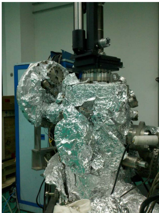
UHV超高真空测试腔体：本底真空优于 10^{-8} Pa
