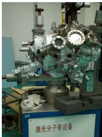
PLD薄膜生长并原位电子结构测量
