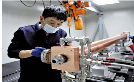
国内首次成功研制弧形腔、内水冷的 S 波段加速管，完成微波测试，正在进行高功率测试
