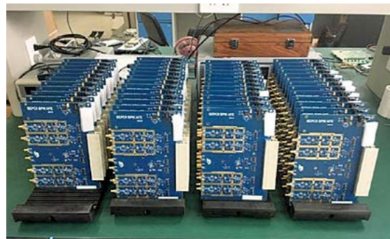
自研 BPM 批量样机完成调试，实验室闭轨分辨率达到 21\text{nm} ，正在 BEPCII 上带束测试
