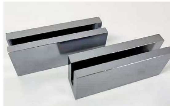
Channel-cut 晶体磁力抛光技术开发，实现内侧光学面纳米粗糙度、低应力抛光
